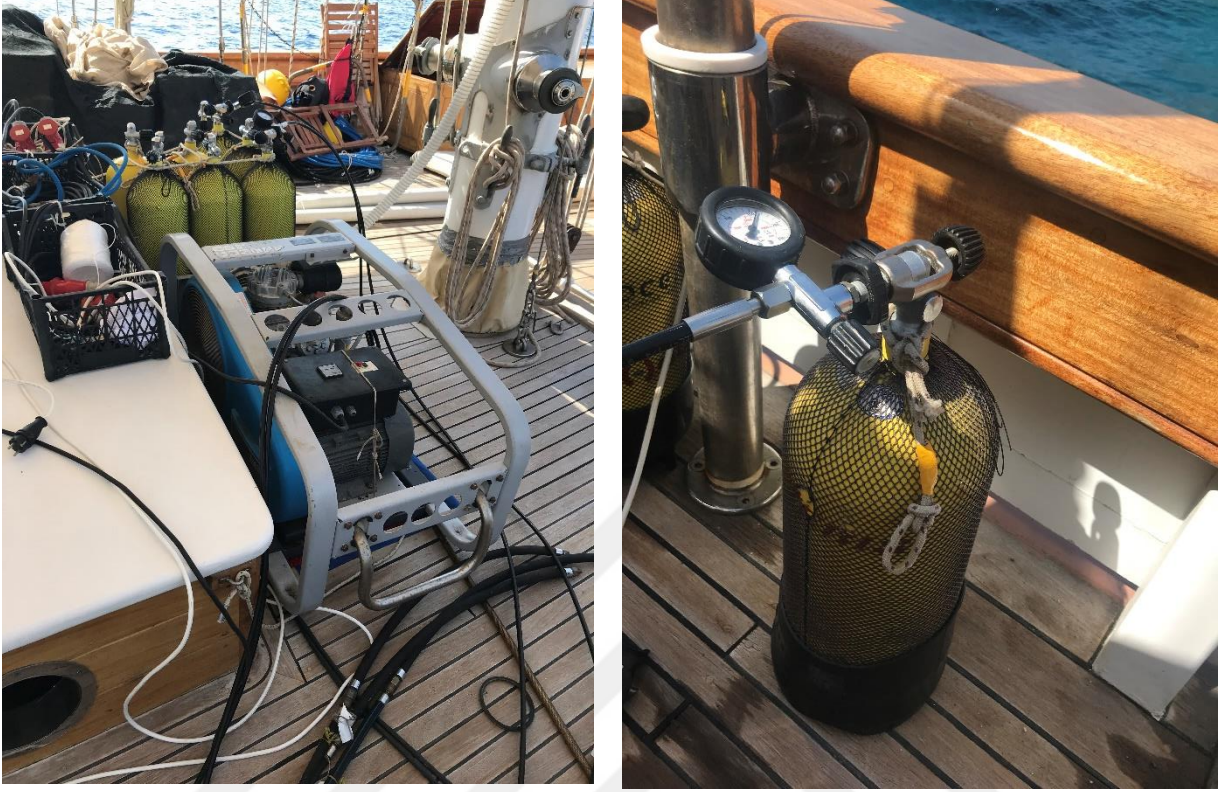
Şekil 1. Kompresör ve doldurulan tüp
