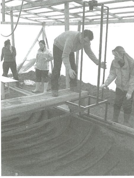
Fotoğraf 6-7. Batık üzerine kurulan fotomozaik aparatı ile 30x40cm 2 lik dik açılı fotoğraflar elde edilmiştir.
