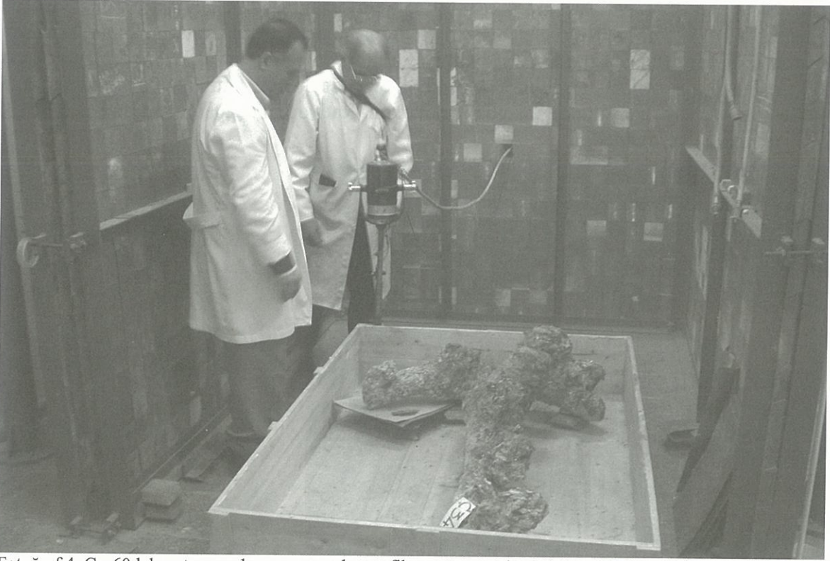
Fotoğraf 4. Co-60 laboratuvarında çapanın radyografik muayeneye hazırlanması. (Fotoğraf: Ufuk Kocabaş)
