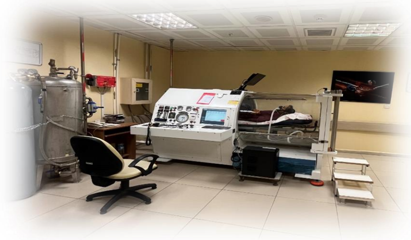
Şekil 2.1. SBÜ Gülhane Eğitim ve Araştırma Hastanesi Sualtı Hekimliği ve Hiperbarik Tıp Anabilim Dalı'nda kullanılan tek kişilik basınç odası
