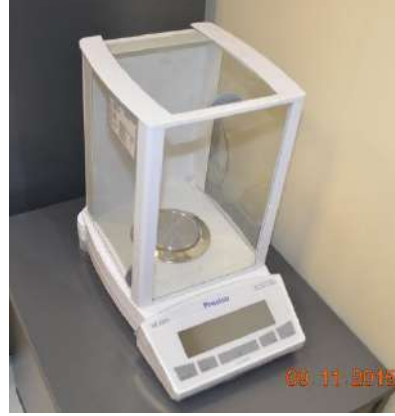
Resim 3.1. Filtre kağıtlarının ve naylon uçlu swab çubuğunun ağırlıkları hassas terazi (Precisia model, İsviçre) ölçülmüştür.
