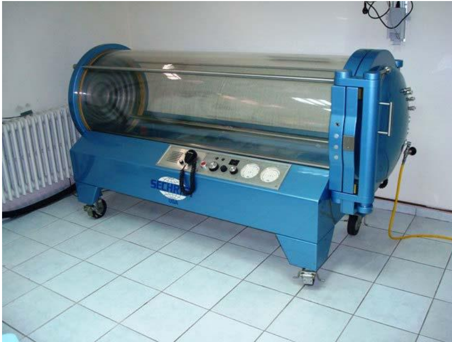
Şekil 1. Tek kişilik basınç odası
