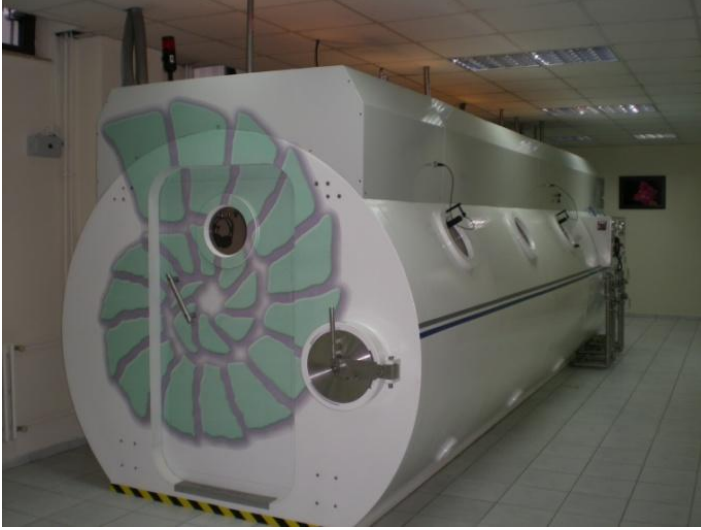
Şekil 2. Çok kişilik basınç odası (İstanbul Tıp Fakültesi Sualtı Hekimliği ve Hiperbarik Tıp Anabilim Dalı)
