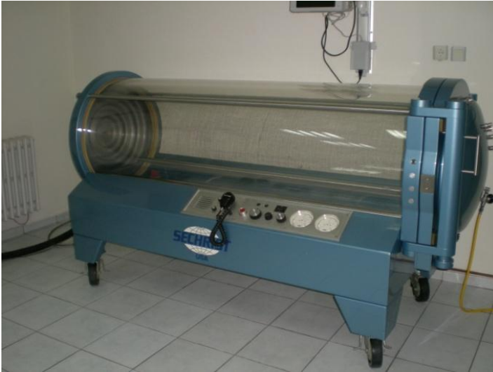
Şekil 1. Tek kişilik basınç odası (İstanbul Tıp Fakültesi Sualtı Hekimliği ve Hiperbarik Tıp Anabilim Dalı)
