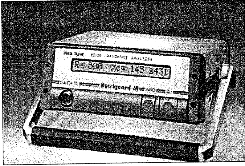
Şekil 8. Biyoempedans analizlerinin yapıldığı BEA-Analizör Nutriguard M Faz Sensitif Multifrekans Analizörü Cihazı (Data Input, Darmstadt, Germany)
